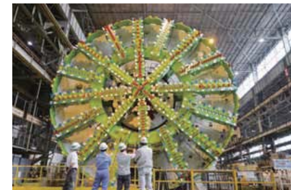
国内最大断面のシールドマシン
