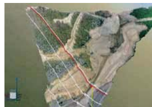
ICT土工の採用(3次元測量による情報化施工例)
