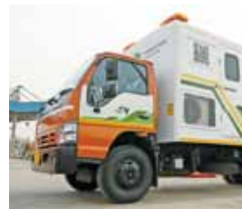
路面性状測定車「E-NEXCO Eye」
