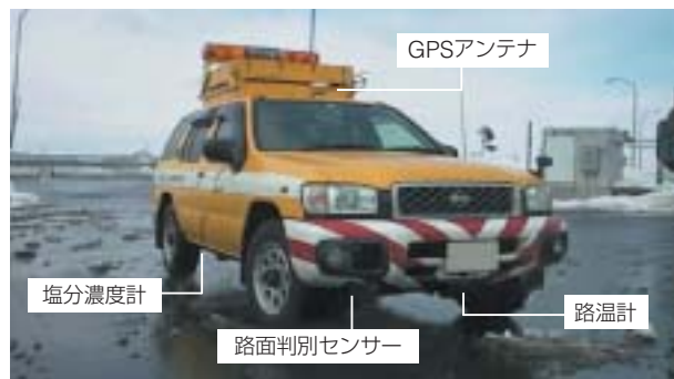
路面情報測定車 雪氷車両に、路温計、路面判別センサー、気温計、塩分濃度計などを搭載。自動的に適切な凍結防止剤散布量を判断し、散布します。
