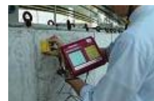
コンクリート構造物における鉄筋かぶりの確認
