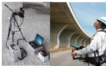
小型ビデオカメラや赤外線カメラを用いた点検技術
