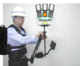
小型ビデオカメラや赤外線カメラを用いた点検技術
