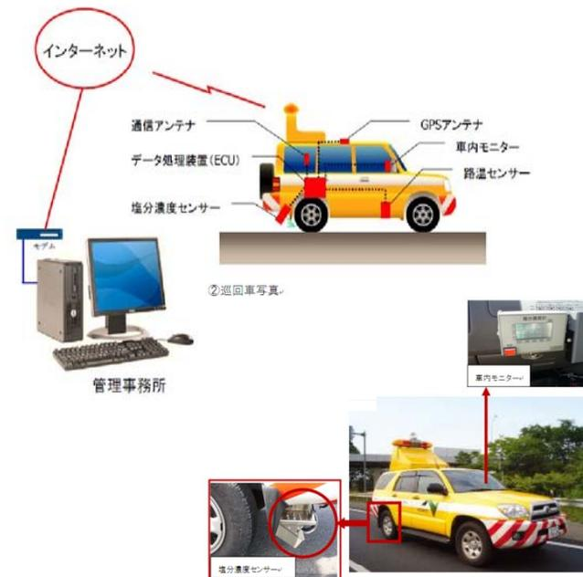
ITS技術を活用した「車載型塩分濃度測定センサー」は、路面の塩分濃度、路面温度、路面状況判別を光学的に測定。
