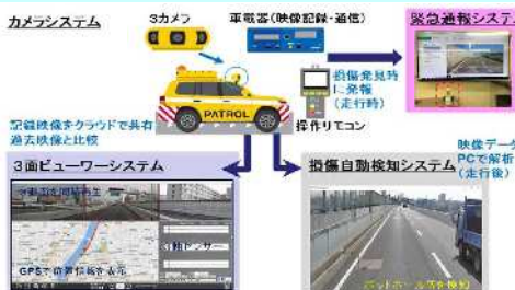
出典: ICTを活用した道路巡回の効率化(例: InfraPatrol(首都高速道路(株)))
