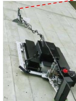
コンクリート壁面を 吸着走行しながら点検
