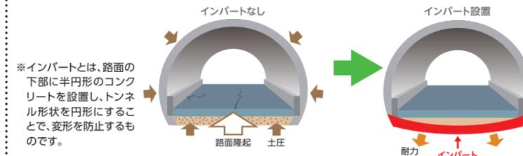
※インバートとは、路面の下部に半円形のコンクリートを設置し、トンネル形状を円形にすることで、変形を防止するものです。
