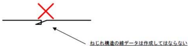
図 5-7 線データの作成（ねじれ構造の禁止）
