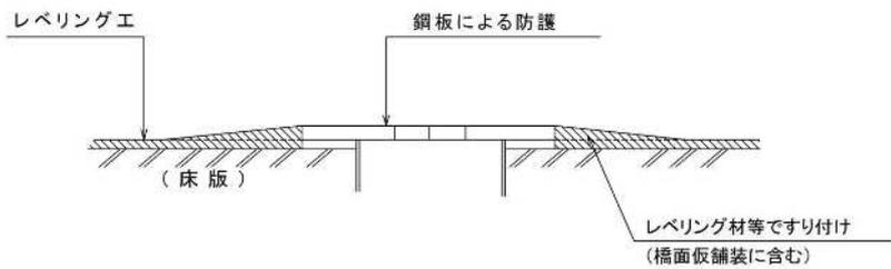
本線内を工事用道路として利用する場合で、橋梁の伸縮装置箇所の段差は正及び伸縮装置の損傷を防ぐ目的で鋼板を設置するもの。
