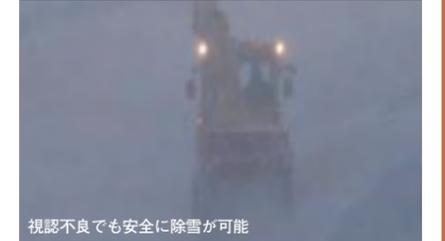
さらなる準天頂衛星の利活用および技術開発により、高速走行（約50km/h）での除雪作業支援、ロータリー除雪車の自動操舵技術の開発に取り組んでいます。
