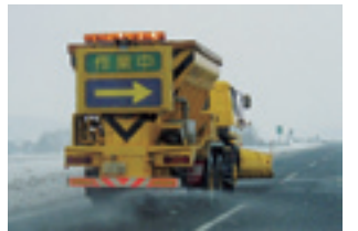
凍結防止剤散布作業
