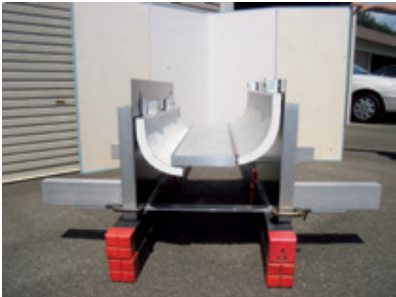
新素材を用いた橋梁伸縮装置の防音構造
