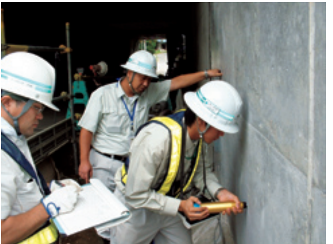
コンクリートの非破壊強度確認試験
