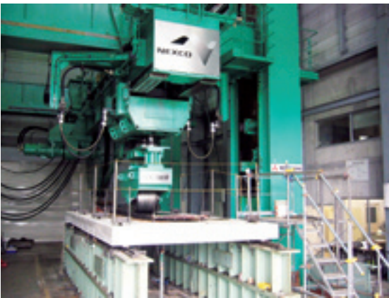
実物大の試験が可能な移動載荷疲労試験機
