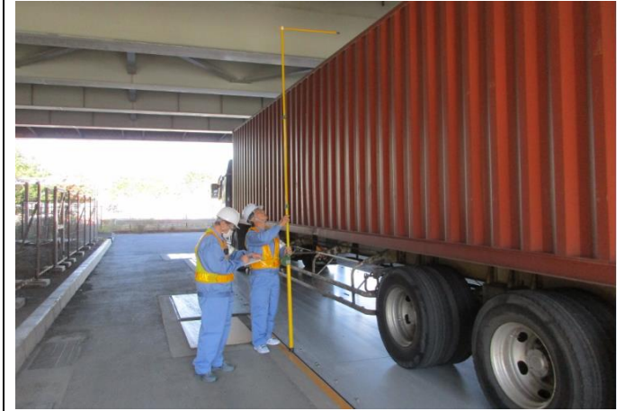
③【東京国道事務所】辰巳車両取締基地 ＜寸法計測風景＞
