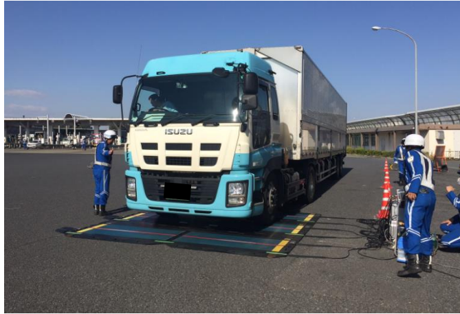
②【東日本高速道路(株)】新座本線料金所 ＜マットスケールによる重量計測風景＞
