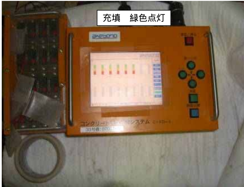
コンクリート充填完了確認
