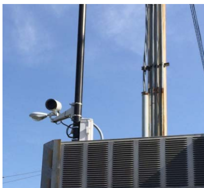
赤外線カメラで自転車や歩行者を識別する取組み
