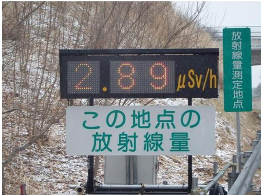
広野～常磐富岡間に設置されたリアルタイム線量表示板。本線や料金所入口など5か所に設置。
