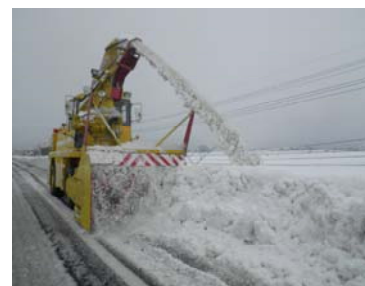
雪氷対策作業状況(路肩除雪)
