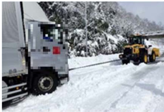
▲ 登坂不能車両のけん引作業状況
