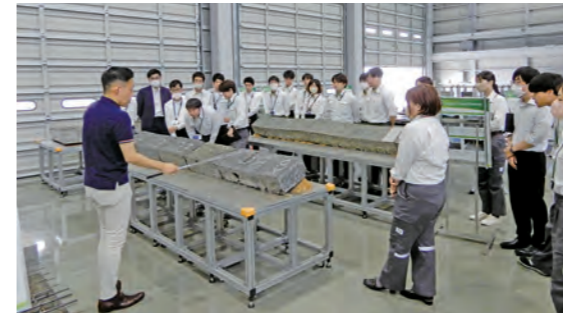
現場から撤去した舗装の一部や断面供試体
