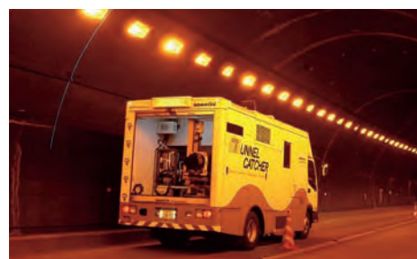
高速クラック計測車によるトンネル内の点検
