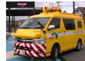
▲ 施設多機能測定 ETC設備・ハイウェイラジオ等の電界強度、道路照明等の照度等を測定
