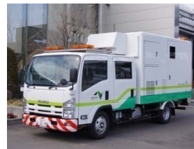
▲ 路面性状測定 高速走行でレーザー光線を投射し、路面のわだち割れ・平坦性を調査
