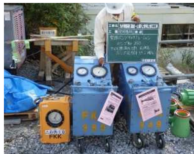
緊張ポンプキャリブレーション
