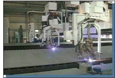
プラズマ切断
