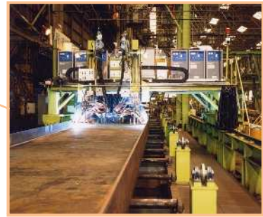
※腹板・フランジの溶接
