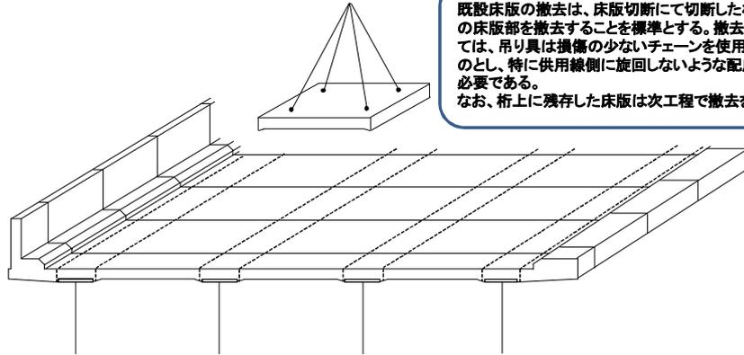
既設床版の撤去は、床版切断にて切断した桁間の床版部を撤去することを標準とする。撤去に際しては、吊り具は損傷の少ないチェーンを使用するものとし、特に供用線側に旋回しないような配慮が必要である。
