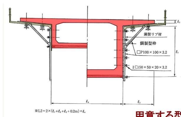
用意する型枠の大きさは、高さ、長さとも、施工するブロックの最大寸法をクリアできるものとする
