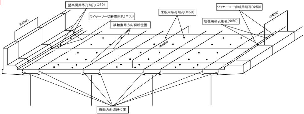
橋軸方向の床版切断は、各主桁部両端をカッターで切断することを標準とする。
