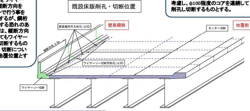
剥離用孔(ジャッキアップ用)と吊孔については、基本的には兼用とするが、撤去で吊った際に著しくパランスが悪い場合はこの限りではない。孔についてはφ50mm程度でコア抜きを標準とする。
