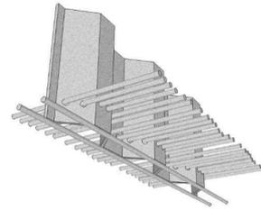
波形鋼板ウェブを直接コンクリート床版に埋め込むもので、鋼フランジやずれ止めを必要としない接合方法です。
