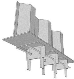
鋼フランジに溶植されたアングルジベル(L型鋼)によりコンクリート床版と波形鋼板ウェブとを一体化とする接合方法です。
