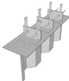
鋼フランジに溶植されたアングルベル(L型鋼)によりコンクリート床版と波形鋼板ウェブとを一体化とする接合方法です。
