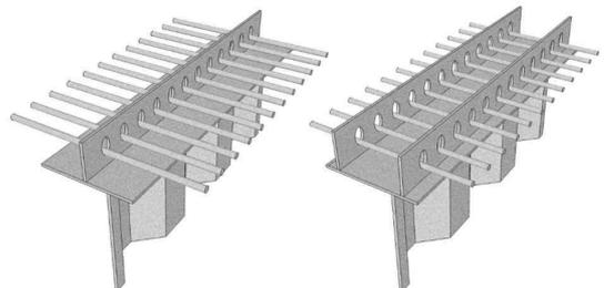
孔のあいた鉛直リブ付きの鋼フランジを波形の上端(または下端)に溶接する接合方法です。
