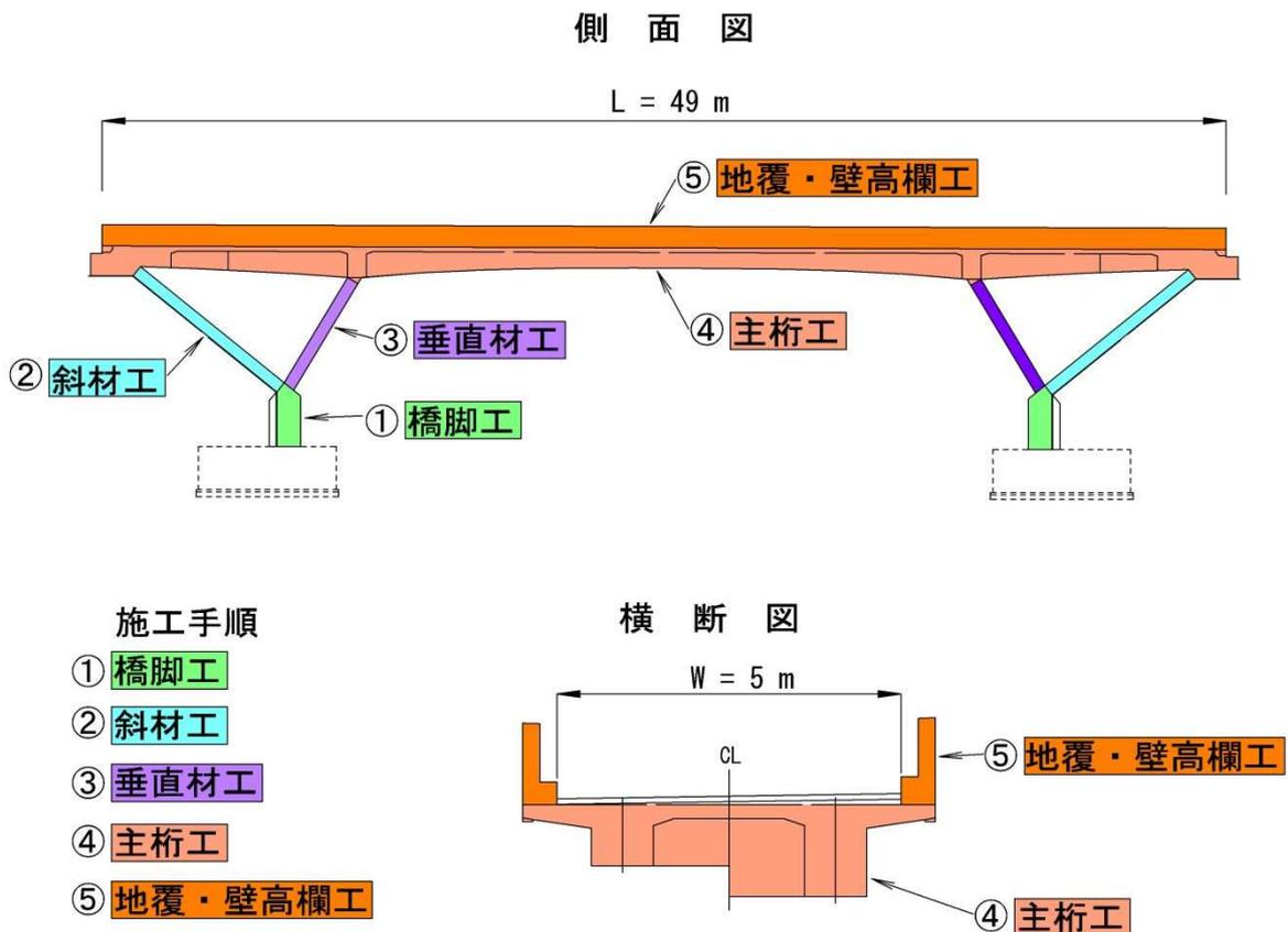
④工程表\_固定式支保工架設工法（斜材付きπ型ラーメン橋）
