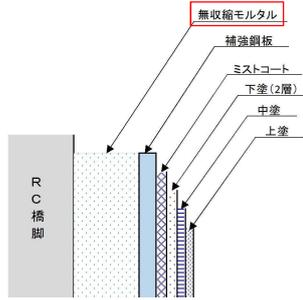
※構造図は充填材が無収縮モルタルの場合
