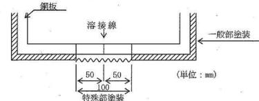
・溶接部の素地調整（G-c）は、電動工具による。
