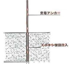
・取付アンカーの削孔は既設構造物の鉄筋に損傷を与えないよう十分な注意を払わなければならない。
