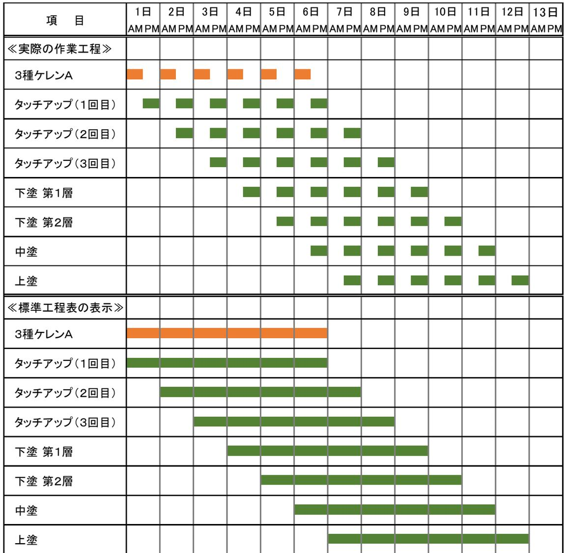
図 5-14-6 塗装面積 500 m<sup>2</sup>当たりの 3 種ケレン～塗装作業までの施工工程（概念図）
