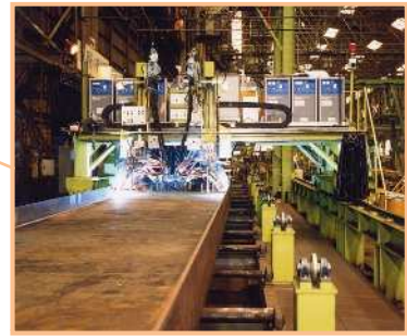
※腹板・フランジの溶接
