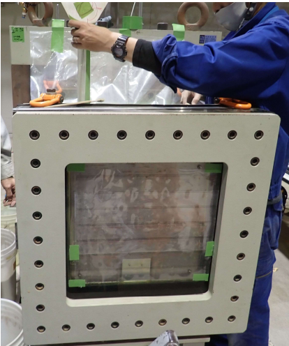
写真 2 空中落下法による地盤作製状況
