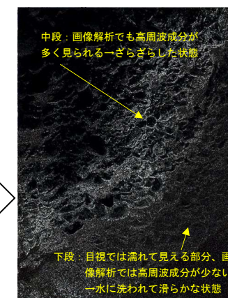
図 3-12 洗われた砂礫層と細粒分の付着する砂礫層(320° 方向)
