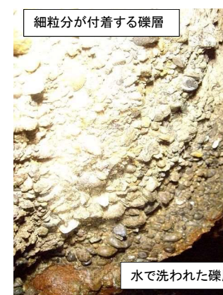
図 3-12 洗われた砂礫層と細粒分の付着する砂礫層(320° 方向)
