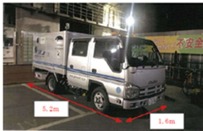
路面下空洞探査車(車載型レーダー)
