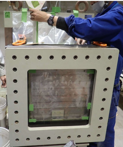
写真 5-2 空中落下法による地盤作製状況
