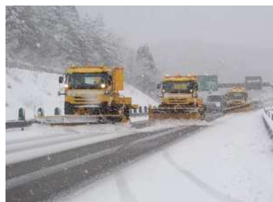
【雪氷対策作業状況(本線除雪)】
