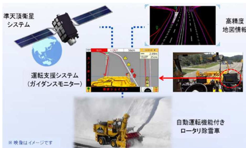
【準天頂衛星を活用したロータリ除雪車自動化】
