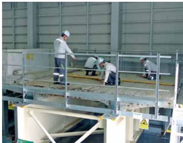
橋梁床版の実物供試体
