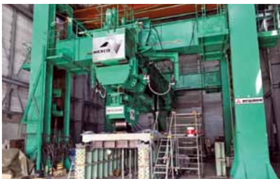
移動載荷疲労試験機 (NEXCO総研)
