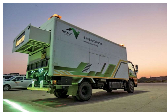
路面性状測定車両「E-NEXCO Eye」
