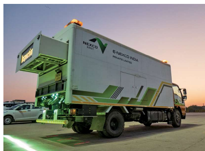
路面性状測定車両「E-NEXCO Eye」
