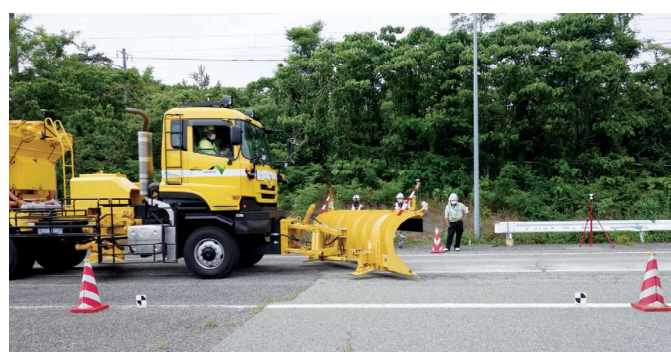
新潟支社テストフィールドにおける除雪ブラウ自動操作の様子
