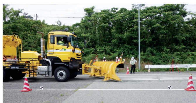
新潟支社テストフィールドにおける除雪プラウ自動操作の様子
