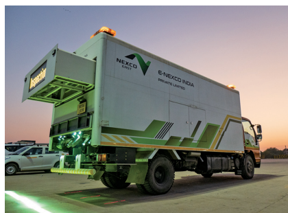
路面性状測定車両「E-NEXCO Eye」
