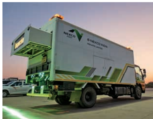
路面性状測定車両「E-NEXCO Eye」
