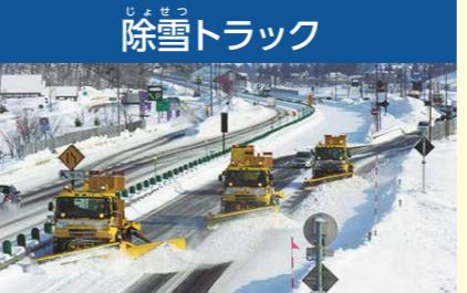
トラックの前に「プラウ」(板状の除雪器具)を付けて雪をかきながら走り、積もった雪が踏み固められる前に、道路の端に寄せる。2～3台で出動し、チームプレーで作業する。
