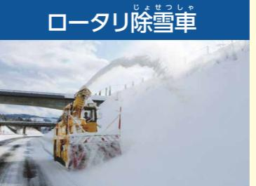
道路の端にたまつた雪を、回転装置(オーガ)の力で切りくすして吸い込み、数メートル先の道路外の安全などを飛ばす。
