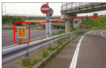
(高速道路出入口部に進入禁止看板)
