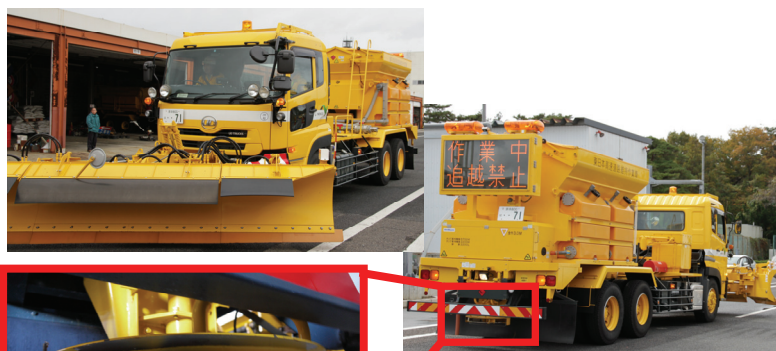
湿塩散布車(スノーブラウ付) 後ろのタンクに塩と水を別々に積み込み、混ぜて湿塩化し、下部の散布円盤(赤枠)が回転し、湿塩を広範囲に散布する。円盤は角度、回転速度を変えることで、散布範囲を調節できる優れもの。
