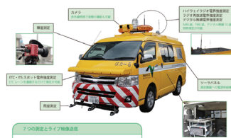
施設多機能測定車「はか〜る」 電波や照度など7つの測定と、 現地ライブ映像の送信が可能。
