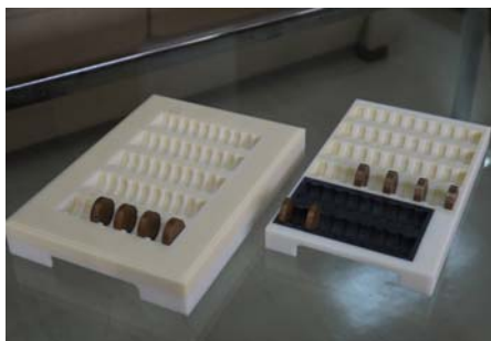
左: 試作品。肉厚でずっしりと重い。 右: 改良品。試作品に比べ、薄く、軽い。 30円エリア(黒い部分)を制作。
