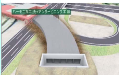
▲ハーモニカ工法+アンダーピニング工法
