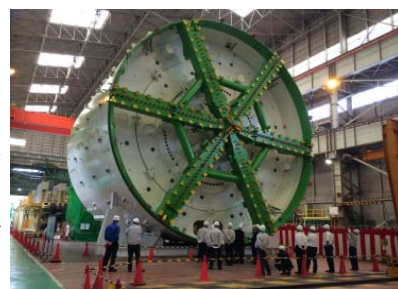
▲外径13.27mのシールドマシン
