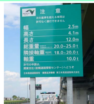
入口に設置されている車両制限令の注意看板
