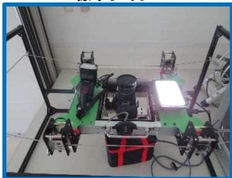
床版下面のひび割れなどの 点検に威力を発揮
