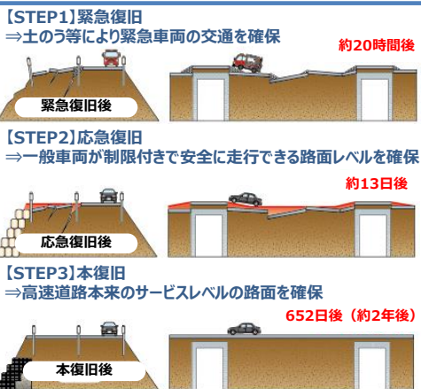
▲高速道路の3段階による災害復旧作業
