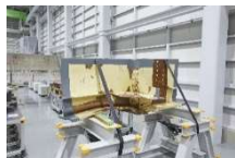
熊本地震で損傷した本線橋の桁
