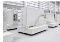
初期欠陥を模擬した供試体
