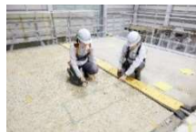
非破壊検査※機器の検査用供試体
