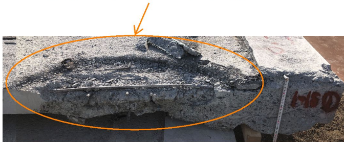
床版上面の土砂化有
