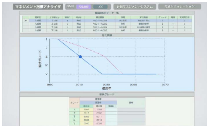
【図-3：構造物劣化傾向の可視化】
