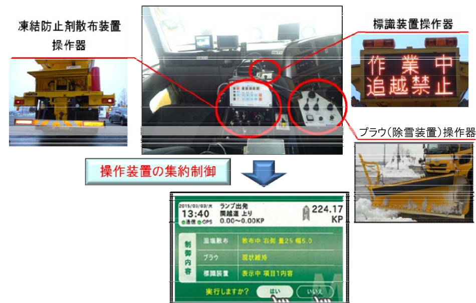
▲雪氷車両の集約制御システムの概要
