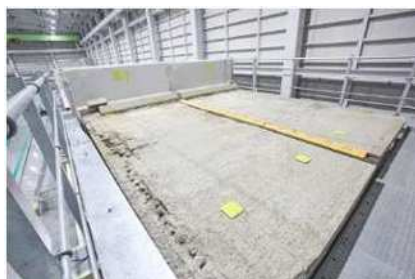
実物供試体による体験型研修設備 劣化した橋梁床版(左)、損傷した舗装(右)
