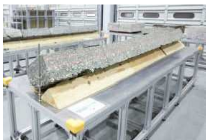
実物供試体による体験型研修設備 劣化した橋梁床版(左)、損傷した舗装(右)
