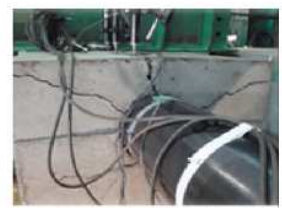
コンクリートと鋼管の実物実験
