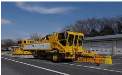
《防護柵切替車両(BTM)》
