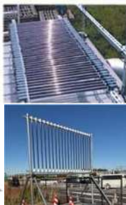
円筒形太陽電池 (電気通信大学と共同研究中)
