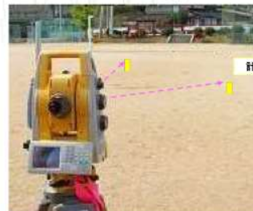
自動測量イメージ(トータルステーション)
